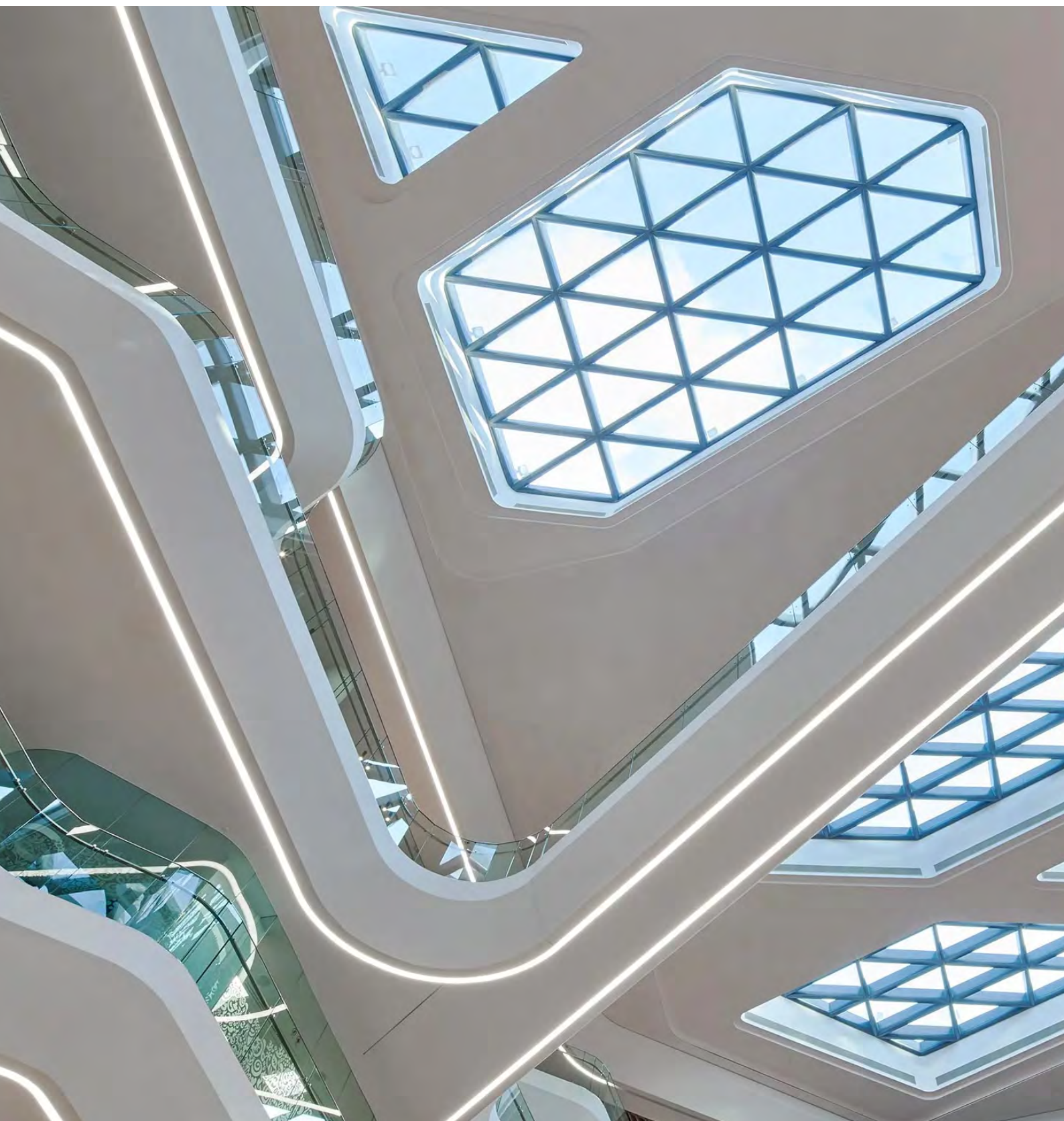
從下仰望，得益於無縫吸聲吊頂，天花板與連接通道降低了中庭的回音
